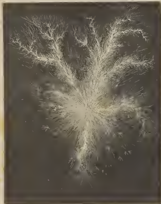
Fig. 3. — Descarga positiva de una máquina de Wimshurst
